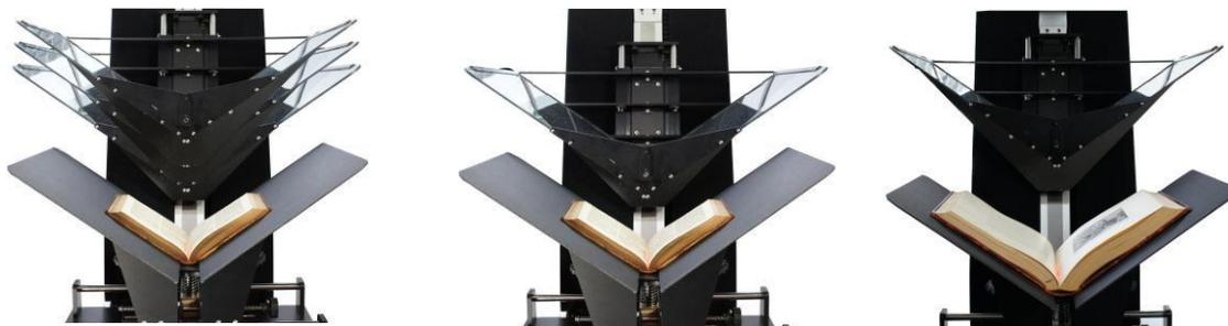
Modulo per l'ottimizzazione dei percorsi di traslazione della lastra di vetro con adattamento automatico alle dimensioni del libro. La lastra di vetro si solleva fino a quando è necessario per ruotare comodamente le pagine. In questo modo si ottiene il massimo grado di efficienza e si riducono i tempi di processo.
