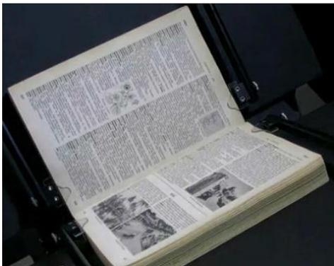
Pressione motorizzata a forma di V, particolarmente delicata con 4 dita di pressione
